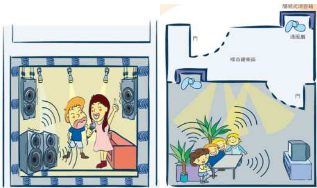
圖 4 擴音設施之噪音防制措施
